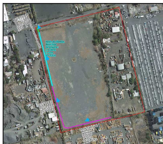
Ouvrages de gestion des ruissellements
